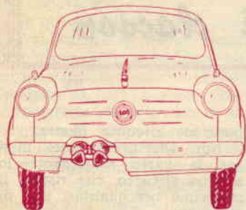
Fig. 2. — Nella vettura FIAT 600 le trombe vengono installate come indicato a figura.
